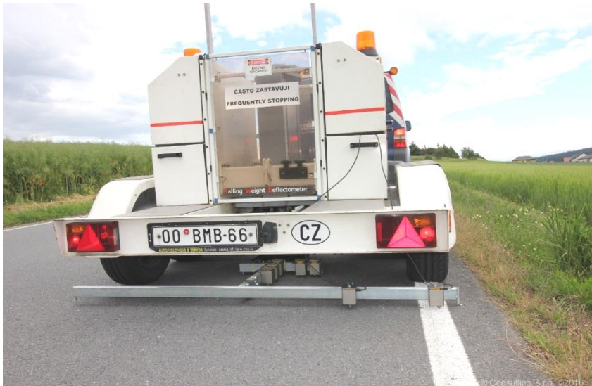
Zadní část měřícího vozidla s úpravou – příčným měřícím rámem
