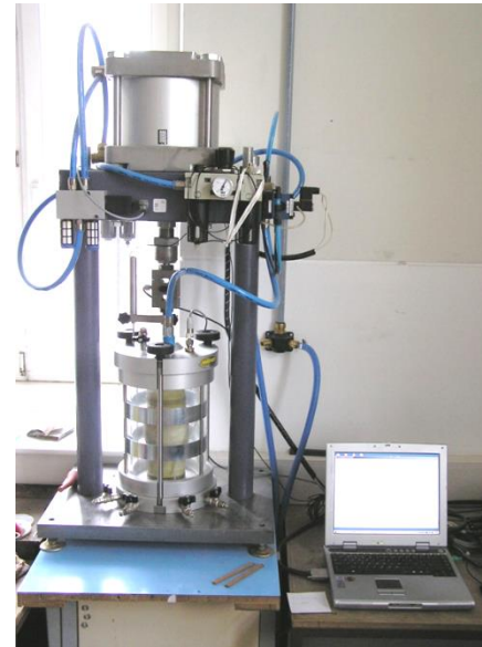
Přístroj na provádění cyklické triaxiální zkoušky za účelem stanovení modulů pružnosti nestmelených směsí používaných do podkladních vrstev vozovek
